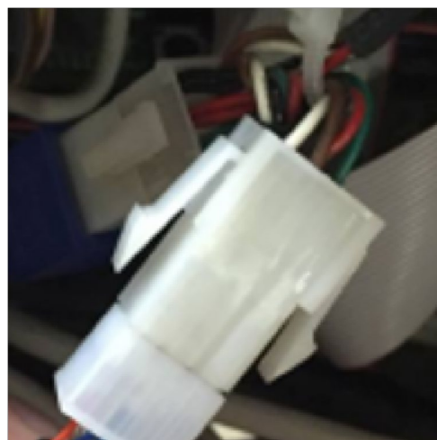
3. Кабель AUX который подключается к разъему AUX Подключение вилки MDB к плате автомата
